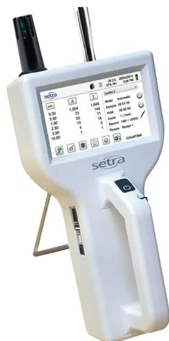
Setra Systems SPC8000手持式空气粒子计数器是功能更先进、用途更广泛的远程粒子计数器，可以测量0.3  $\mu\text{m}$ 到25  $\mu\text{m}$ 、流量0.1 CFM (2.83 LPM) 的粒子。
