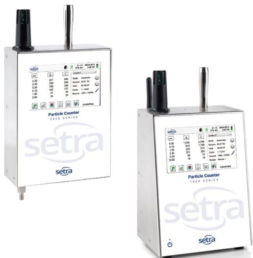
Setra Systems SPC5000和SPC7000是功能更先进、用途更广泛的远程粒子计数器系列，可以测量0.3  $\mu\text{m}$ 到25  $\mu\text{m}$ 、流量0.1 CFM (2.83 LPM) 的粒子。每台仪器都可以通过以太网、USB或（可选的）无线802.11 b/g、RS485或RS232轻松集成至楼宇自动化和洁净室管理系统。SPC7000系列还可用作独立的电池运行设备。
